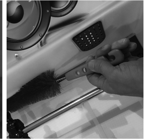
UTILICE UN PLUMERO FLEXIBLE PARA LIMPIAR EL CANAL DE BAJADA DE LA BOLA USE A FLEXIBLE DUSTER TO CLEAN THE BALL RUN
