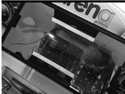
LEVANTAR PROTECCIÓN TRANSPARENTE DE LA PLACA SAM9 RAISE TRANSPARENT PROTECTION OF THE SAM9 PCB
